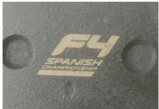
Lado del pistón de la pastilla / Piston side of the pad
